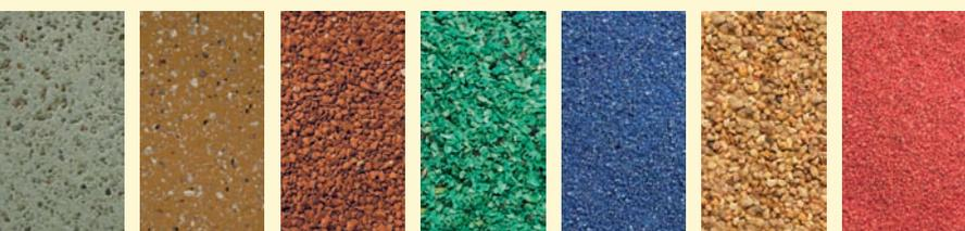
La réalisation de nuances colorées tient à l'association des teintes standard de l'enduit avec celles des granulats qui sont directement projetés à la surface de l'enduit.
